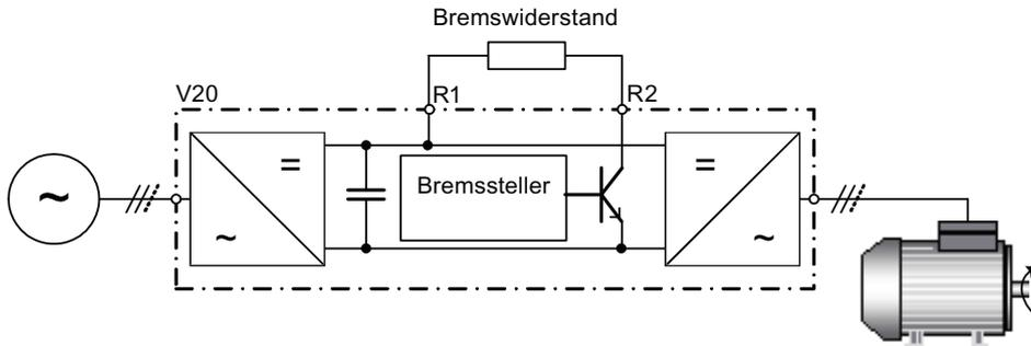
Die Dauerleistung  $P_{DB}$  und das Lastspiel für den Bremswiderstand lassen sich mit dem dynamischen Bremsmodul (für die Baugrößen A, B und C) oder über den Parameter P1237 (für Baugröße D) ändern.
