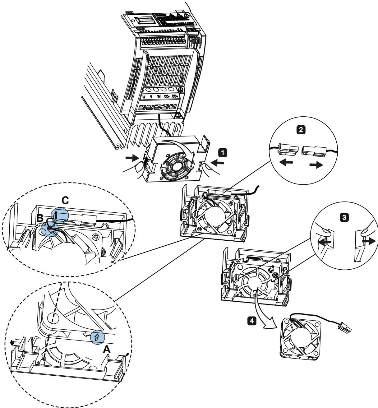
Austausch des Lüfter/der Lüfter bei Baugröße B, C oder D
